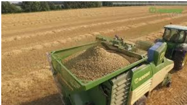
Fahrbare Pelletier-Anlage der Firma Krone beim Einsatz von Strohpelletierung im Feld.
